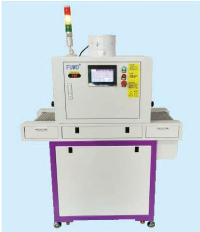
落地型隧道式UV-LED光固化装置，采用触摸屏控制，输送带可正反转调节，方便不同应用需求，其光源采用UV-LED冷光源，低温，节能；高光功率输出，光强连续可调，光照均匀；是替代传统汞灯及卤素灯的最佳方案。广泛应用于光学、电子(消费类电子/汽车电子/微电子)及半导体、医疗、印刷包装、板材后处理等领域。
