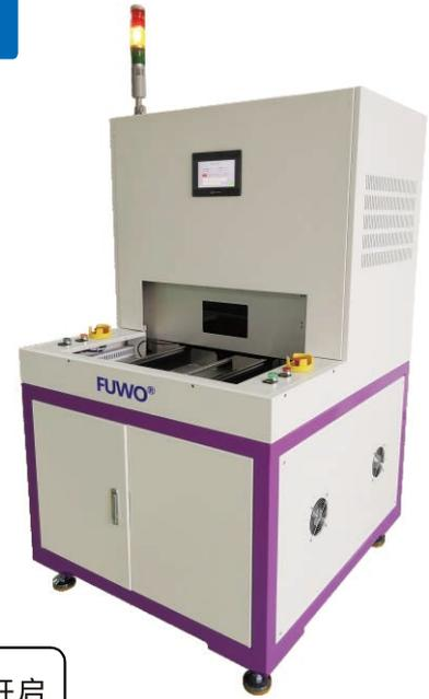
本装置采用单工位固化方式，满足客户产品的同时，又具有高效率性，照射头高度可调节功能，高度调节范围20-300mm，采用水冷的冷却方式，配有报警灯（带蜂鸣器），装置固化参数带有触摸屏调节，内设有密码管理功能。设备进出料口配有遮光板，遮光板高度220mm，带腰孔，可调节，能满足不同产品的需求。
